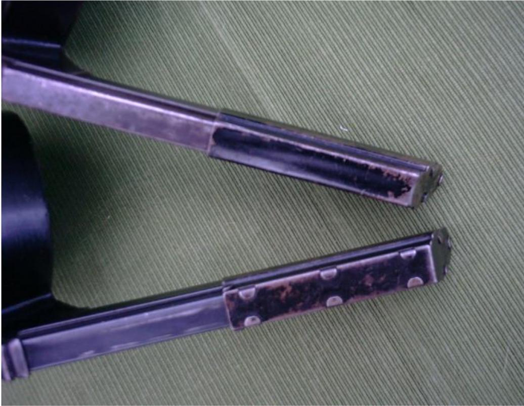
Enfin l'adaptateur pour le MP18 est lui toujours avec les palettes de renfort idem du dernier type et possède une lame ressort interne pour se bloquer sur le corps du trommel:
