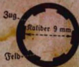
der Luft verhindert wird. Die zwischen den Zügen stehengebliebenen Teile des Laufinnern heißen Felder. Der Durchmesser des Laufes, der von Feld zu Feld gemessen wird, heißt Kaliber. Er beträgt rund 9 mm.
