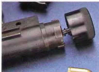
Una volta rimosso il corposo tappo di culatta è possibile separare dall'arma la molla di recupero e il massiccio otturatore, il che consente di procedere in modo agevole e corretto alle operazioni di pulizia
