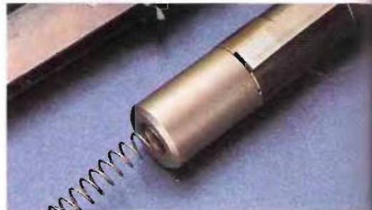
La molla di recupero è ospitata in un canale scavato nella sezione posteriore dell'otturatore ed è investita su una corta asta di guida recante un pulsante terminale che protrude dal tappo di culatta.
